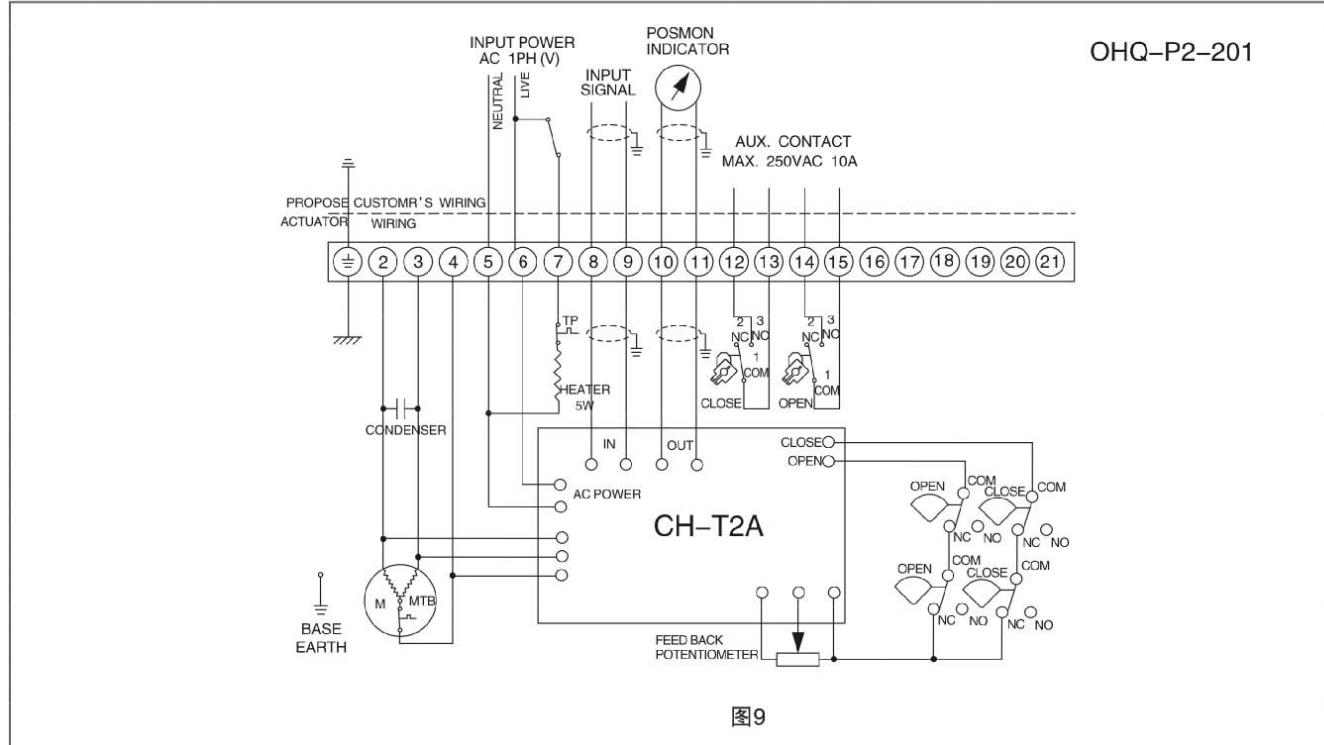
5.OHQ-015 ~ 500 380V/440V AC/50/60HZ,3相(外置标准型) OHQ-K3-W201
